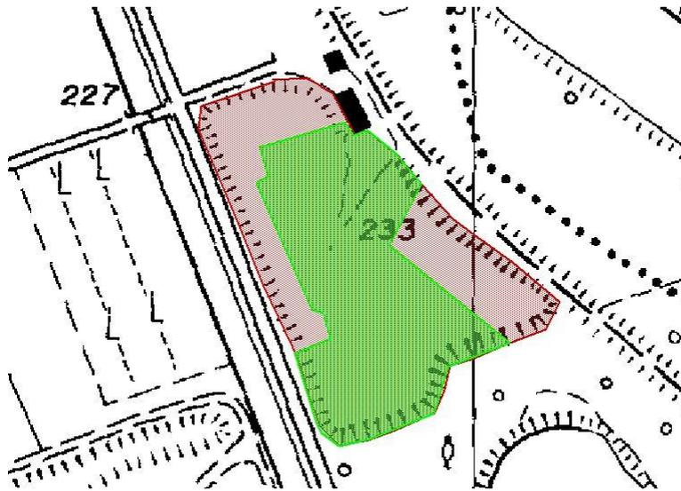
In base alla quota dei due pozzi di raccolta del percolato (necessariamente inferiore alla quota del fondo vasca), la base delle vasche nord ed est del nuovo lotto (rosso) risultano ubicate a circa 217.5 e 216.2 m s.l.m. Assumendo per il primo lotto (verde) una quota del fondo vasca di 215 m s.l.m., la volumetria del corpo rifiuti risulta pari a circa 350.000 m<sup>3</sup>.
